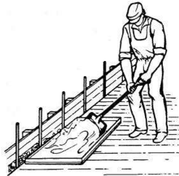
Рис. 74. Использование настила при бетонировании стены
