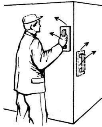
Рис. 208. Отделка углов при оштукатуривании поверхности
