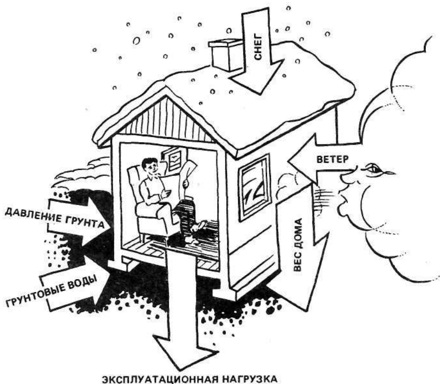
Рис. 23. Нагрузки, действующие на дом
