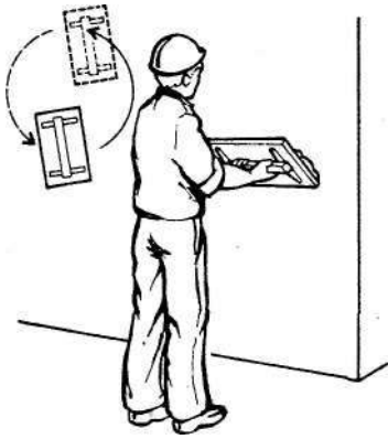
Рис. 207. Применение полутерка при доводке поверхности
