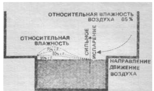
Рис. 5.17. Схема деформации граничного слоя воздуха и переходных слоев при движении воздуха
